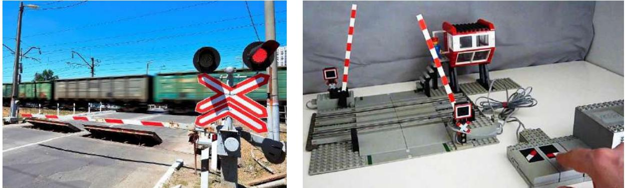
**Железнодорожный переезд** — место пересечения в одном уровне железных дорог с автомобильными дорогами (трамвайными путями, троллейбусными линиями), либо велосипедной или пешеходной дорожками, и в зависимости от условий работы оборудуются одним из следующих устройств: автоматической светофорной сигнализацией; автоматической светофорной сигнализацией с автоматическими шлагбаумами; автоматической оповестительной сигнализацией с неавтоматическими шлагбаумами.
