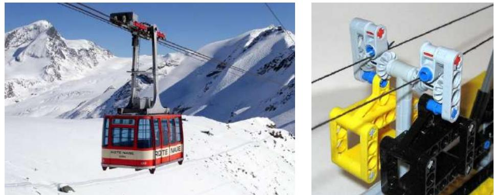
**Канатный подвес** – это транспортирующие машины, тяговым и грузонесущим элементом которых является канат, подвешенный на опорах над поверхностью земли
