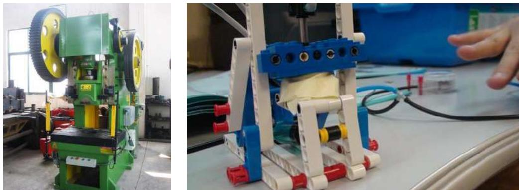
**Пресс** — механизм для производства давления с целью уплотнения вещества, выжимания жидкостей, изменения формы. На производстве прессы чаще всего используются,
