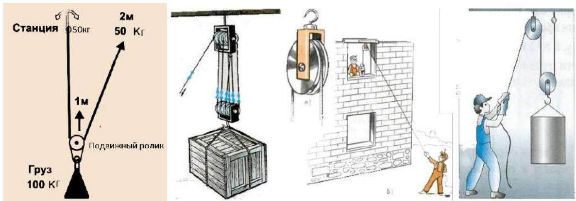
Если закрепить верёвку на станции (первая схема) и пропустить её через ролик на грузе, для поднятия груза необходимо усилие в 2 раза меньшее, чем его масса. Выигрыш в усилии – 2:1. В этой схеме ролик подвижный, потому что он движется вверх вместе с грузом. Чтобы поднять груз на 1 метр, кончику верёвки необходимо переместиться на 2 метра. Это – схема самого простого полиспаста 2:1. В этой схеме нагрузка на станцию – 50 кг.
